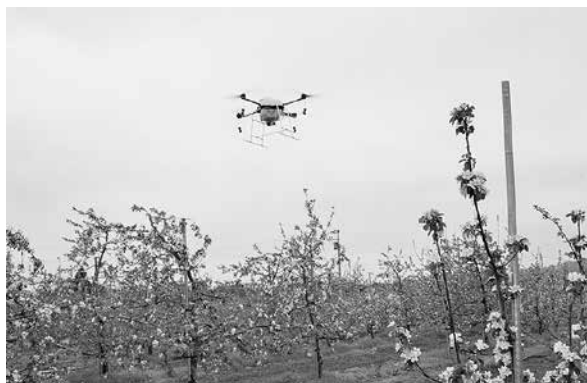
授粉用溶液を散布するドローン
