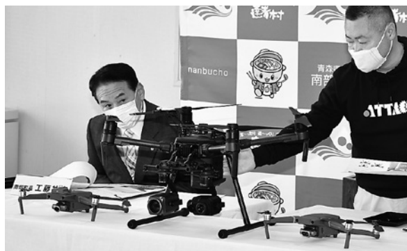
左右にある小型のものが町で購入したドローン それぞれ望遠と赤外線のカメラを備えています
