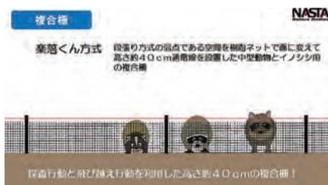
図12 楽落くん方式は物理柵によって面を作ることによりに空間との境になる上部を探索する行動を利用した技術。
