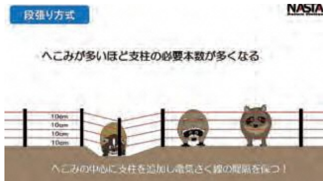
図8 支柱を増やして地表面と電気さく線の間隔が広がらないようにする。へこみが多いと支柱の本数が多くなるので事前に地ならししておくとうい。
