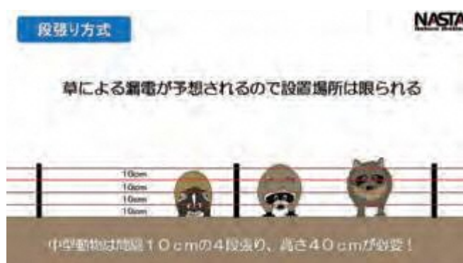
図6 中型動物に対しては電気さく線の間隔を10cm以下にする必要がある。草による漏電のリスクが高くなるので設置場所が限られる。
