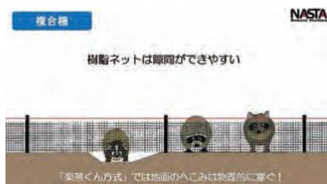
図13 楽落くん方式を設置する場合は地表面を整地することが基本だが、樹脂ネットでは隙間がしやすい。
