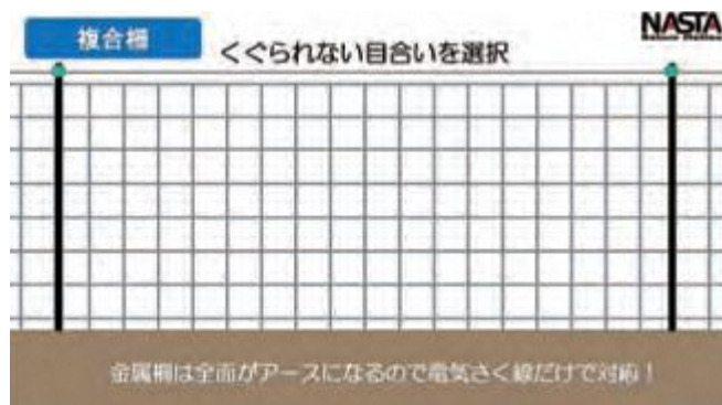
図10 金属さくの場合は全面がアースになるので上部に電気さく線を設置することで対応可能。目合いは抜けられない5cm以下にする。(電落くん方式)
