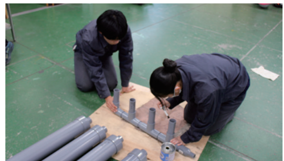
熱交換器を組み立てている様子
