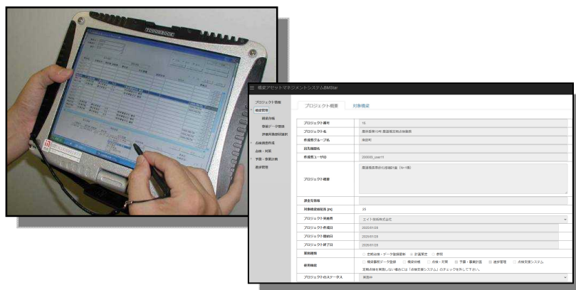
図5-3 点検支援システム機材
